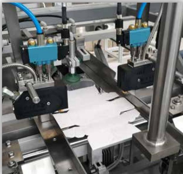
Die MKF Auftragskopfsreihe bietet zwei Modulooptionen: Bead oder Zero Cavity. Bead-Mini-Module arbeiten mit geraden, 90° und kugelförmigen Standarddüsen. Zero-Cavity-Minimodule ermöglichen einen extrem schnellen und genauen Leimauftrag mit jedem Klebstofftyp.
