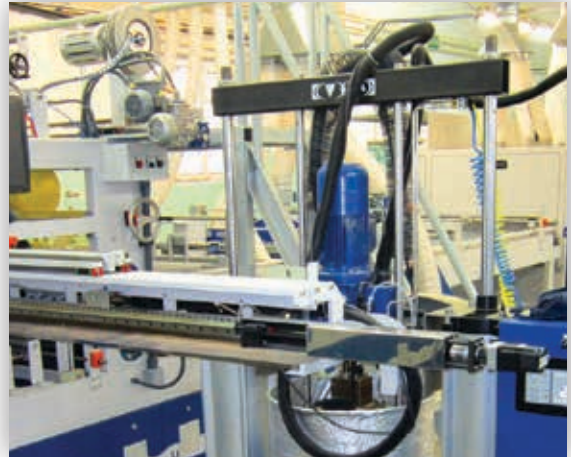
Sicherstellung eines gleichmäßigen Auftragsgewichts mit motorischer Breitenverstellung in Verbindung mit der Steuerung des Auftragsgewichts.
