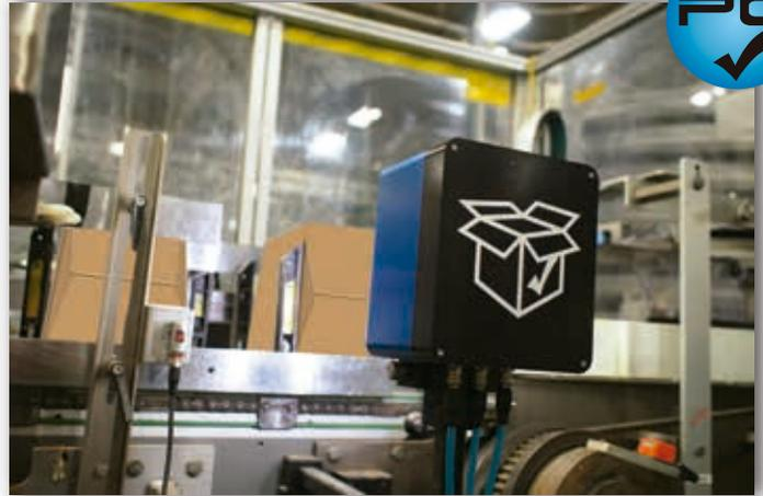
PACKCHEK™, INSTALLIERT AUF EINER KARTONIERMASCHINE MIT EINEM SCHMELZKLEBERSYSTEM
