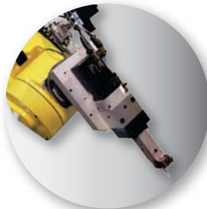
Der Rotationsmesskopf Fluid Kinetics RM1000 wird am Handgelenk eines Sechs-Achs-Knickarmroboters angebracht
