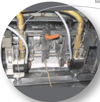
Ventil 524 beim Auftragen von Leimpunkten in einer Faltkarton-Klebmaschine
