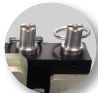
Schnellspannrings ermöglichen einen werkzeug-losen, besonders schnellen Wechsel der Beleimung von Innen- und Außenseite.
